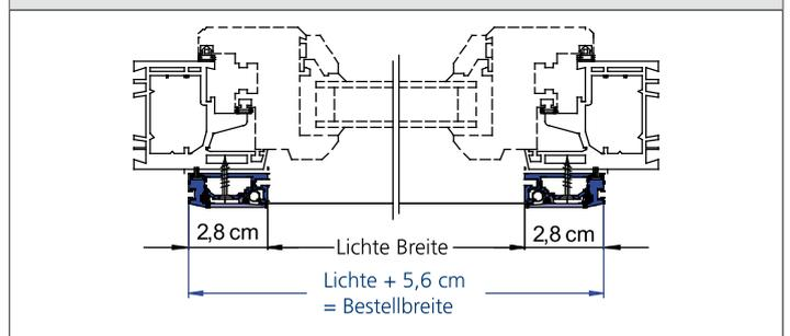
**HORIZONTALSCHNITT ROLLADEN SOFTFÜHRUNGSSCHIENE**
