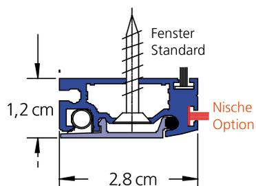
Aluminium; stranggepresst; 28 x 12 mm; pulverbeschichtet; auf Gehrung geschnitten; inkl. Aluminium Blende als Abdeckung für unsichtbaren Keder
