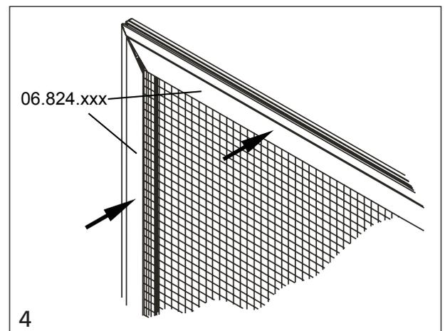
Die Blende mittels festem Druck einclippen.
