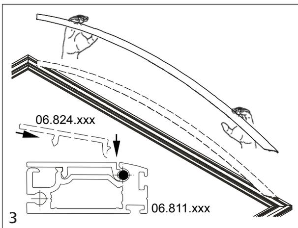
Blende 06.824.xxx leicht überbiegen und mit den Ecken voraus in die hintere Nut (mit eingelegter Rundschnur) wie im Querschnitt dargestellt einstecken.
