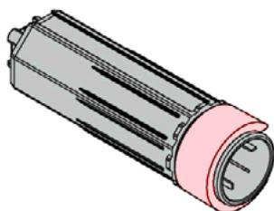
Federkapselsicherung (roter KU-Ring) entfernen.
