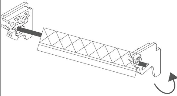
Vorspannen (ca. 23 Umdrehungen, bei kleinen Abmessungen (Breite unter 70 cm) ca. 20 in Abwickelrichtung) und Gegenseite ebenfalls in vormontierte Einhängung platzieren.
