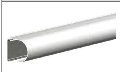
2 mm starkes Aluminium; stranggepresst; einteilig; Oberfläche pulverbeschichtet; Abmessung 142 x 108 mm; Seitenlager aus Aluminium-Druckguss
