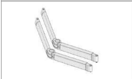
Aluminium; stranggepresst; pulverbeschichtet; Gelenke aus Aluminium-Druckguss; Kraftübertragung mit innenliegenden Doppelfederzügen; geschränkte Bauweise mit linker Arm unten liegend- rechter Arm oben ; zweiteiliger Armschlag
