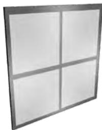
Schieberahmen mit zweiläufigem Montagerahmen und zwei Schiebeelementen. Einfaches Öffnen und Schließen mittels beidseitig bedienbarer Griffleiste. Oben aufgehängte, rollengelagerte, aushängbare Schiebeelemente, einschließlich Sicherheitsausfallschutz gegen unbeabsichtigtes Ausheben der Schiebeelemente. Geeignet für die Montage an Wintergärten, Terrassentüren, auf der Außenwand oder in Nischen.
