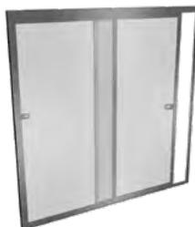
Schieberahmen mit zweiläufigem Montagerahmen und zwei Schiebeelementen. Optisch großzügiger Rahmen ohne Griffleiste. Bedienung mittels elegantem Design-Muschelgriff aus Edelstahl. Oben aufgehängte, rollengelagerte, aushängbare Schiebeelemente, einschließlich Sicherheitsausfallschutz gegen unbeabsichtigtes Ausheben der Schiebeelemente. Geeignet für die Montage an Wintergärten, Terrassentüren, auf der Außenwand oder in Nischen.
