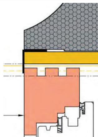
Fensteranschlagleiste aus schlagzähem Hart-PVC in schwarz zur Montageunterstützung von Fenstern als Anschlag.
