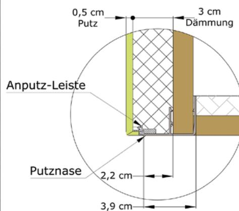
PUTZNASE: Aluminium; stranggepresst; 2 mm; blank; optional; pulverbeschichtet
