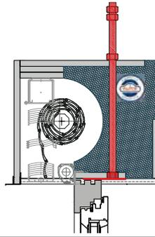
ISO ROLLRAFF Konterplatte aus Niro mit verschweißter Mutter M16, Senkkopfbohrungen zur Befestigung am Sturzkasten und entsprechender Gewindestange M16. Die optional wählbare Konterplatte erfüllt die Funktion als Zuganker zur statischen Ableitung in den Fenstersturz bei großen Spannweiten und besonderen Anforderungen.
