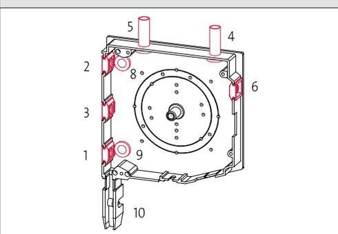
Kabelaustritt des Motorkabels für Sicherheitsrollladen und Sicherheitstor.
