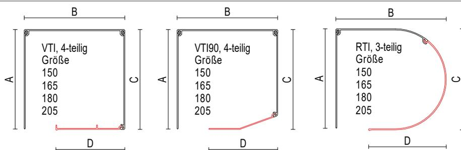
stranggepresst; Aluminium; 2 mm; geschlossener Kasten; Revision von vorne; Form RTI, VTI, VTI90°
