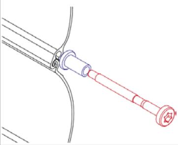
Sicherheits-Führungsschiene (FSS76) 76 x 32 mm inkl. Behang mit Sicherheitsarretierung (Standard). Standardausführung mit verschraubter Sicherheitsarretierung zum Schutz vor dem Herausreisen aus der Führungsschiene.
