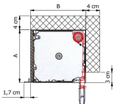
Aluminium; rollgeformt; 1,2 mm; Revisionsblende eckig 90°; 2 mm; inkl. Dichtband zur Fassadenanbindung; alternativ; ohne Putzträger mit vorderer Blende blank; Blendkappe/Seitendeckel in Kastenfarbe mit bündiger Putznase ohne Einputzstreifen; optional; Sturzisolierung mit Dämmung
