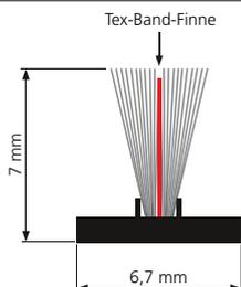
Die Soft-Fin Bürsteneinlage mit Tex-Band Finne sorgt für einen sanften und ruhigen Lauf des Rollladenbehangs. Sie wird bei den Führungsschienen der Mini-Rollläden sowie der Softführungsschienen bei der Rollladen Komplettierung verwendet. Sie bietet gegenüber Neopren-Einlagen den Vorteil, dass sie weicher und geschmeidiger bleibt.
