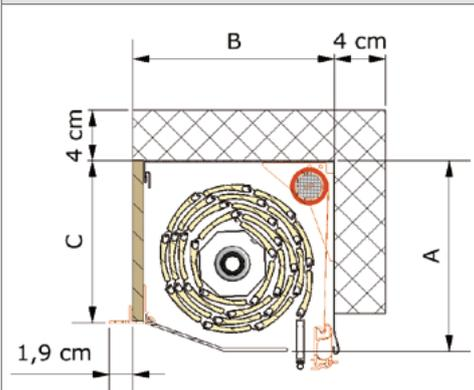
Aluminium; 2 mm; stranggepresst; Revisionsblende eckig mit 20° Schräge; inkl. Dichtband zur Fassadenanbindung; alternativ; ohne Putzträger mit vorderer Blende blank; Blendkappe/Seitendeckel in Kastenfarbe mit bündiger Putznase ohne Einputzstreifen; optional; Sturzisolierung mit Dämmung
