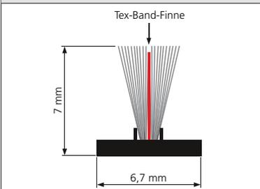
Die Soft-Fin Bürsteneinlage mit Tex-Band Finne sorgt für einen sanften und ruhigen Lauf des Rolladenbehangs. Sie wird bei den Führungsschienen der Mini-Rollläden sowie der Softführungsschienen bei der Rollladen Komplettierung verwendet. Sie bietet gegenüber Neopren-Einlagen den Vorteil, dass sie weicher und geschmeidiger bleibt.
