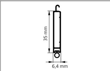
Aluminium; stranggepresst; pulverbeschichtet; 35 x 6,5 mm; mit verdrehbarem T-Gleiter; inkl. Gummidichtprofil; optional; Endleistenschloss (ELS); Schubriegelsperre (SUS)
