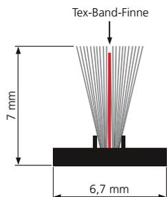
Die Soft-Fin Bürsteneinlage mit Tex-Band-Finne sorgt für einen sanften und ruhigen Lauf des Rolladenbehangs. Sie wird bei den Führungsschienen der Mini-Rolläden sowie der Softführungsschienen bei der Rolladen Komplettierung verwendet. Sie bietet gegenüber Neopren-Einlagen den Vorteil, dass sie weicher und geschmeidiger bleibt.
