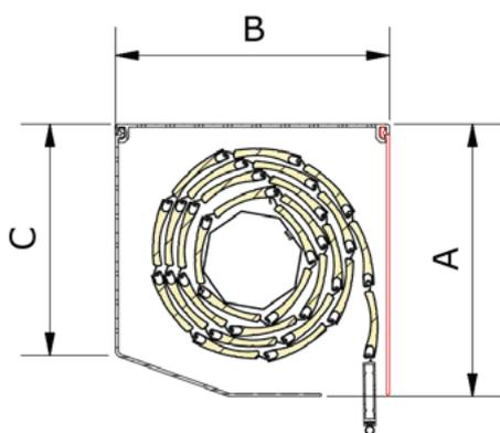
Aluminium; 2 mm; stranggepresst; Revisionsblende eckig mit 20° Schräge; inkl. Dichtband zur Fassadenanbindung; alternativ; ohne Putzträger mit vorderer Blende blank; Blendkappe/Seitendeckel in Kastenfarbe mit bündiger Putznase ohne Einputzstreifen; optional; Sturzisolierung mit Dämmung
