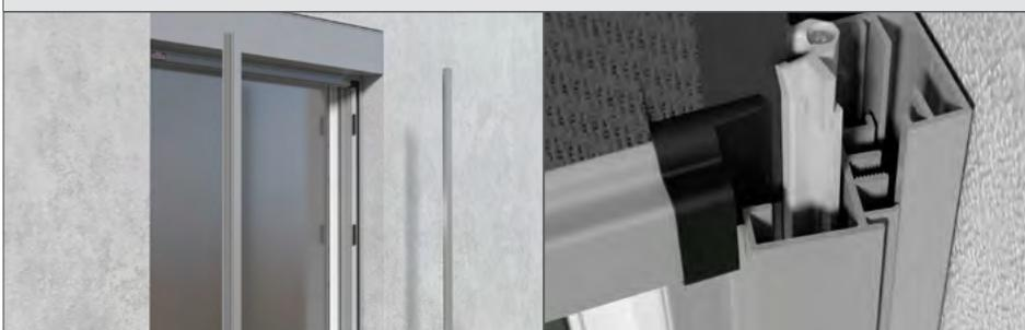
Die Abdeckung der Führungsschiene aufschieben und diese auf der Führungsschiene festdrücken. Es ist keine Verschraubung der Abdeckung notwendig.
