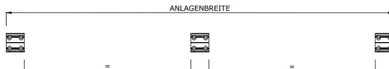
Montieren Sie die Montagekonsolen an die Wand. Der Abstand der beiden Außenseiten der Montagekonsolen ist gleich der Gesamtbreite der BAHAMA-ZIP. Teilen Sie die zusätzlichen Montagekonsolen gleichmäßig über die gesamte Breite auf.
