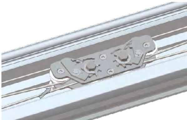
Bringen Sie den Kordelspanner im Fallprofil an und befestigen Sie diesen, indem Sie mit einem Schraubenzieher die Kunststoff Führungsblöcke des Kordelspanners drehen.
