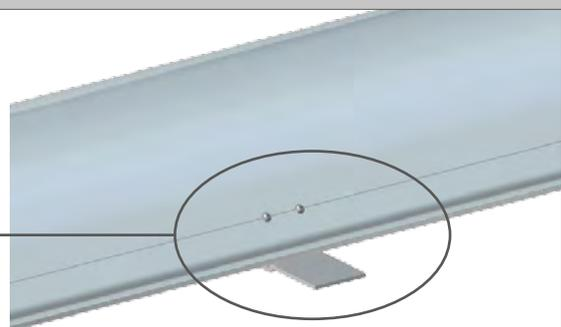
Haken Sie das Dachprofil der Kassette in das Bodenprofil und klicken Sie es fest.
