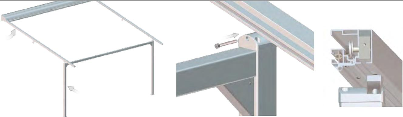
Kippen Sie die Führungsschiene nach oben und positionieren Sie die Bodenstützen an der geplanten Position. Verbinden Sie das Obere- und Untere-Scharnier mit dem Inbusbolzen M8x70.
