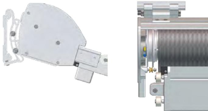
Haken Sie die Kassette an der Montagekonsole ein und sichern Sie die Montagekonsole mit den Inbusschrauben. Stellen sie die Neigung der Beschattung ein, bevor sie den Montagebügel an der Montagekonsole fixieren.
