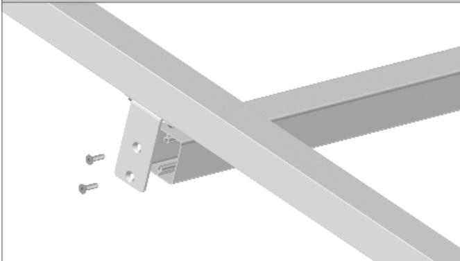
Positionieren Sie den Träger für die Tuchunterstützung mittig des Ausfalls beidseitig auf den Führungsschienen und befestigen Sie das Unterstützungsprofil mit den Schrauben M8x30.
