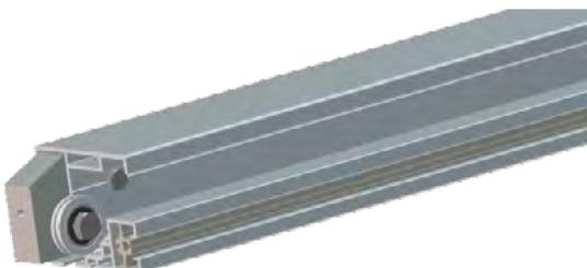
Schieben Sie den Lagerblock in die Führungsschiene und befestigen Sie ihn mit der Metallschraube M6 x 14 mm. Ziehen Sie die Schlaufe der Kordel über die Rolle.
