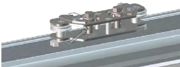
Nehmen Sie den Kordelspanner aus dem Fallprofil, damit sich die Kordeln einfacher um die Rollen legen lassen. Stecken Sie die Kordel durch das Loch im Kordelspanner und ziehen Sie diese leicht auf Spannung. Machen Sie ca. 25 cm hinter dem Loch einen Knoten in der Kordel und schneiden Sie den Kordelrest unter dem Knoten ab.
