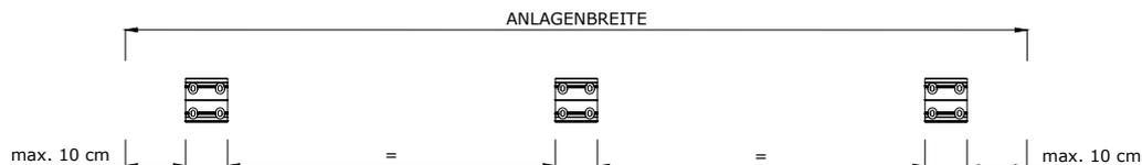
HINWEIS: Bei der Montage ohne Seitenabdeckung kann die Montagekonsole optional bis max. 10 cm nach innen gesetzt werden.
