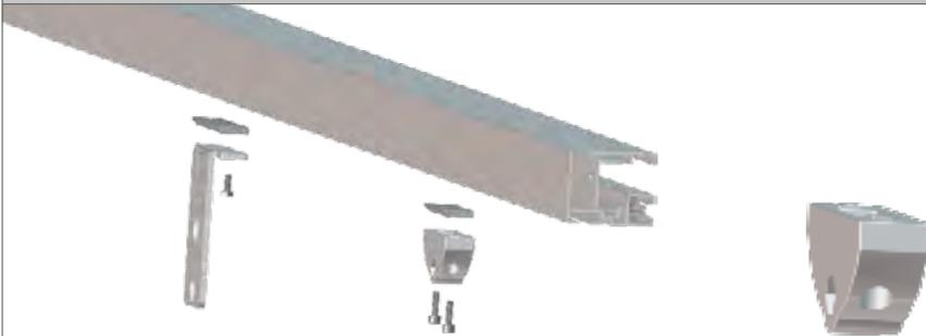
Schieben Sie die Klemmplatten / Nutensteine in die Führungsschiene und befestigen Sie darauf die Konsole für die Tuchunterstützung (bei einem Ausfall von über 350 cm) und das Obere-Scharnier.
