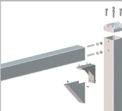
Montieren Sie das Querprofil / Sparren zwischen den Stehern und befestigen Sie das Untere-Scharnier auf dem Steher. Zur Aussteifung montieren Sie das Aussteifungsdreieck inkl. Abdeckung zwischen Steher und Querprofil. Stecken Sie die Abdeckkappen auf.
