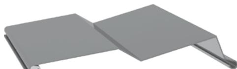
Z-förmige Lamelle, beidseitig randgebördelt, aus hochfester Aluminiumlegierung einbrennlackiert, tiefgezogene Aufzugsbandstanzung zur Schonung der Aufzugs-Textbänder, Metallführungszapfen wechselseitig mit jeder Lamelle vernietet, Lamellen mit fixierter Dämpfungslippe, Farbauswahl lt. gültiger Kollektion; **WENDUNG: 90°**
