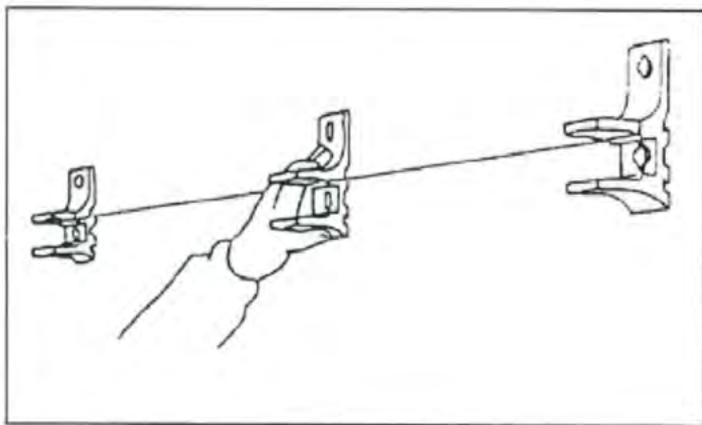
Die beiden äußersten Halter leicht befestigen und eventuell weitere Halter mittels schnur genau fluchtend ausrichten. Unebenheiten durch Unterfütterung ausgleichen. Alle Schrauben fest anziehen.
