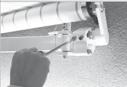
Beide Schrauben des Armes, der verstellt werden soll, lockern.
