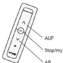
1. Fahren Sie über die Taste "AB" die Markise komplett aus (Antrieb schaltet selbstständig ab).
