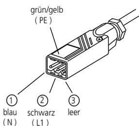
Die Anschlussleitung muss min. 30 cm Restlänge haben. Bei kürzerer Restlänge wird die integrierte Antenne beschädigt und es kann zu Empfangsproblemen kommen.
