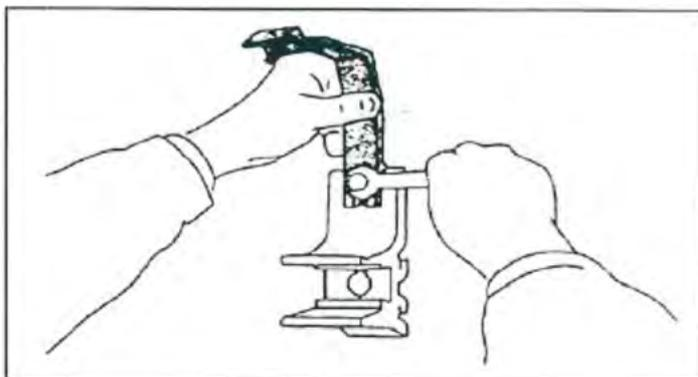
Bei Regenschutzdach werden die notwendigen Haltebügel bei der Halterung mit montiert.
