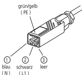
Der drahtgebundene Motor muss entsprechend der Klemmenbelegung angeschlossen werden. Bei Anschlussarbeiten muss die Stromzufuhr unterbrochen werden (Sicherung herausnehmen!).
