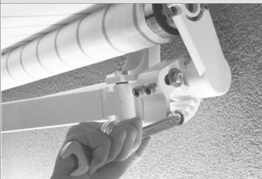
Schrauben lösen und Arm für die Neigung in nächste Einrastung befestigung. Ziehen sie den Schrauben wieder fest an!
