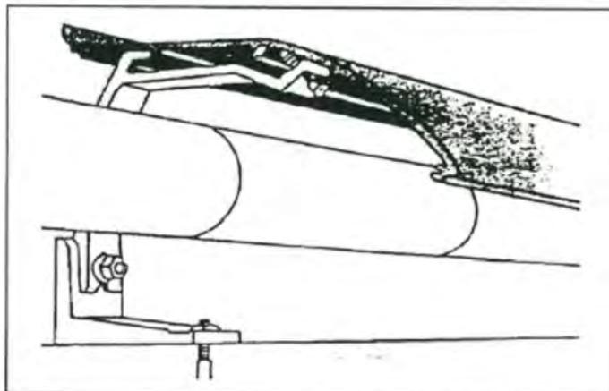
Regenschutzdach mit beiden Nuten von vorne in die Haltebügel einschieben (Dichtlippe zur Wand und nach oben zeigend) und mittels Klemmschrauben festklemmen. Seitenteile mit Schraubendreher anschrauben.
