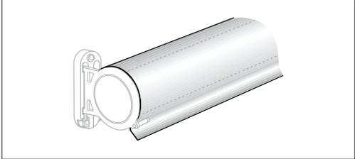
C-förmige Rundhülse aus Aluminium, stranggepresst,  $\varnothing$  123 mm x 2 mm, für den ganzjährigen Wetterschutz von Tuch und Technik. Ausgestattet mit Radien am Tuchaustritt, Tropfkante sowie Kompensation der Längenausdehnung in den Seitenlagern. Aufpreis Aluminium Abdeckung LS, LF
