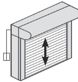
Durch Drücken und Halten der entsprechenden Taste (AUF/AB) bzw. durch Drehen und Halten des Schaltknebels (LINKS/RECHTS) bewegt sich der Rollladen in die gewählte Richtung.
