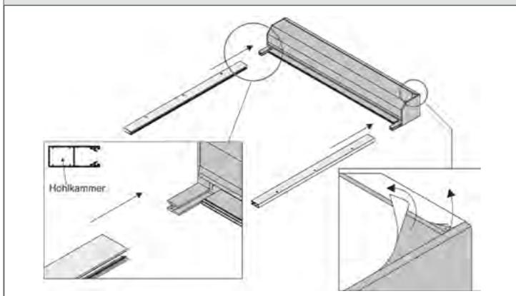
Stecken Sie die Führungsschienen bis zum Anschlag auf die Blendkappenzapfen. Anschließend ist die Schutzfolie von den Blenden und Führungsschienen zu entfernen.
