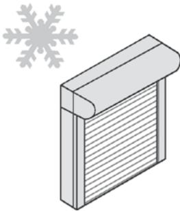
Bei Frost oder gefrierendem Regen kann der Rollladen anfrieren. Vermeiden Sie eine gewaltsame Betätigung und verzichten Sie bei fest gefrorenem Rollladen auf ein Öffnen oder Schließen.
