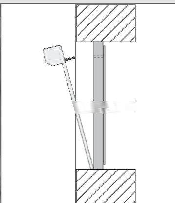
Das Element wie in Abb. in die Laibung vor den Fensterrahmen setzen (zweite Person) und die Feder in die Bohrung im Fensterrahmen einführen. Die Schnur anschließend durch die Feder nach innen führen bzw. den Gurt durch die Bohrung stecken.
