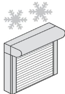
Bei automatischen Steuerungen die Automatik abschalten, wenn ein Anfrieren droht.
