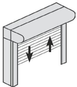
Beim Öffnen den Aufzugsgurt / Wickler / Kurbel etc. im letzten Drittel langsam betätigen. Der Rollladen darf nicht gewaltsam oben anschlagen. Beim Schließen den Gurt / Wickler / Kurbel etc. langsam betätigen. Das Bedienelement nie auslassen.
