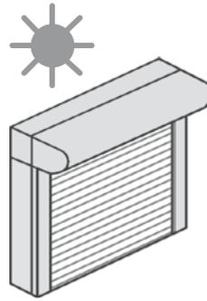
Bei Verwendung von Rolläden als Sonnenschutz empfehlen wir Ihnen, diese nicht vollständig zu schließen, so dass eine Hinterlüftung gewährleistet ist. Bei Kunststoffrolläden wird außerdem die Gefahr von Verformungen verringert.
