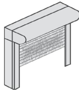
Beim Entriegeln des Insektenschutzgitters ist zu beachten, dass das Gitter mit beiden Händen so weit wie möglich nach oben geführt wird, um Beschädigungen durch zu schnelles oder ruckartiges Einfahren zu verhindern.
