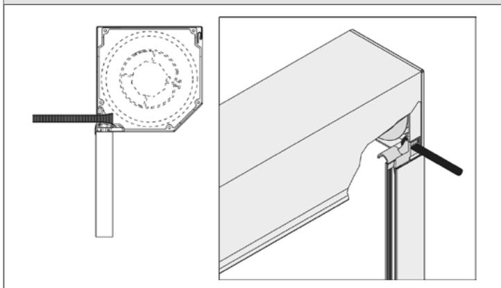
Schieben Sie die Feder (auf der Bedienseite) durch den Einlaufstutzen (s. Abb.).
