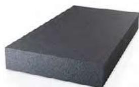
Expandierter Polystyrol-Hartschaum mit Infrarotreflektoren, frei von HFKW und FCKW. Bei gleicher Dämmdicke erhält man eine um ca. 25 % bessere Wärmedämmung und spart so Energie und Kosten.
