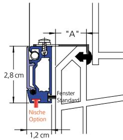
Aluminium; stranggepresst; 28 x 12 mm; pulverbeschichtet; auf Gehrung geschnitten; inkl. Aluminium Blende als Abdeckung für unsichtbaren Keder
